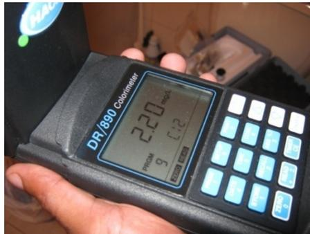
\_Valor de cloro residual otorgado por el colorímetro fotómetro
