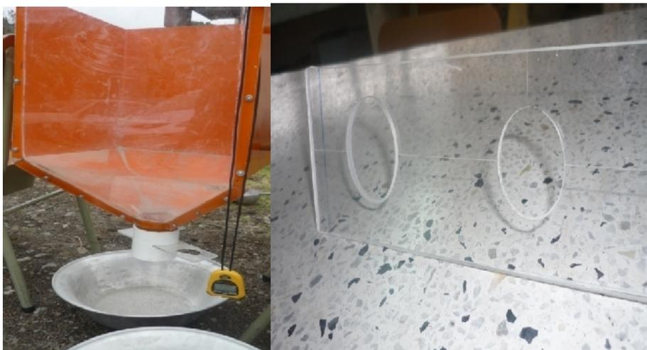
La tabla 13 muestra los aforos realizados en la tolva de almacenaje de sedimentos, con arena blanca. Aquí se afora para los 4 orificios de la tableta de ranuras con el fin de determinar el caudal promedio que se puede suministrarse con cada uno de ellos, posterior mente cada ensayo con un dispositivo hidráulico necesitara un caudal a graduar según las características y condiciones de funcionamiento del dispositivo.
