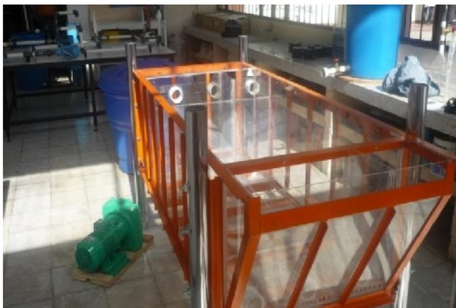
Partes acrílicas recubrimiento de tanque. En la figura 28 podemos observar el trabajo realizado en acrílico para formar las tolvas de almacenaje en el fondo del tanque desarenador, cada pieza cuenta con su molde para tener una simetría entre los componentes.
