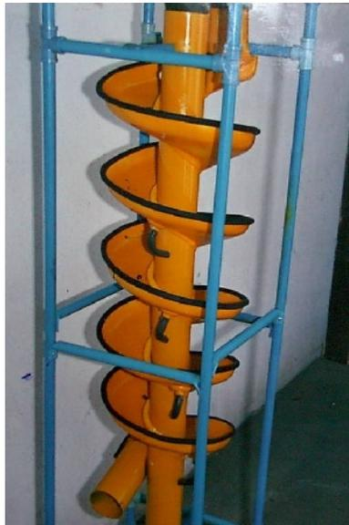
La espiral concentradora es un aparato concentrador basado en la gravedad, que separa material consistente en arena granular (2mm a 0.075mm) con densidad baja de otro material con densidad más alta. El rango de concentraciones
