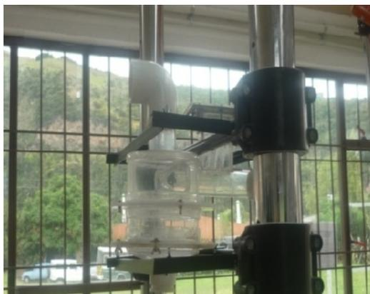
En la figura 34 se puede observar la disposición de la tolva de almacenaje y el dispositivo a ensayar, la ubicación de cada uno puede graduarse gracias a las condiciones de acople a las columnas de soporte por medio de abrazaderas, así se podrá contar con la cabeza necesaria para un determinado ensayo.
