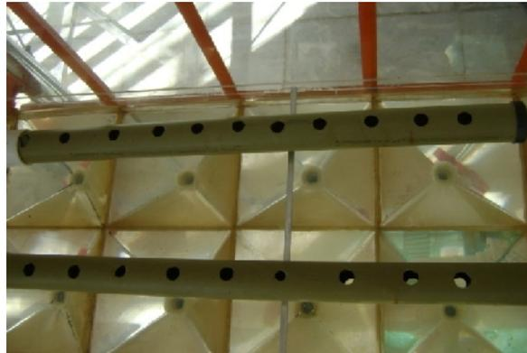
Para el diseño de la zona de entrada del tanque desarenador, se usa tubería PVC debido a la facilidad de acople, ya que una sección cuadrada en materiales acrílicos o plásticos tendría un costo mucho más elevado y un alto nivel de complejidad en su construcción, la tubería es evaluada desde el punto de vista hidráulico, económico y de resistencia, por lo cual se considera como adecuada para su disposición dentro del tanque desarenador<sup>3</sup>.
