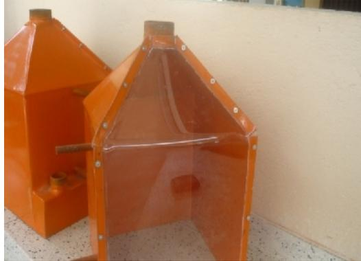
Las tolvas de almacenaje cuentan con un sistema de anclaje a la estructura de soporte, por medio de abrazaderas se asegura a las columnas de soporte, aquí se cuenta con un tornillo roscado que permite dar apertura a la tolva para lograr una buena nivelación y disposición final, la tolva debidamente asegurada se puede observar en la figura 32.
