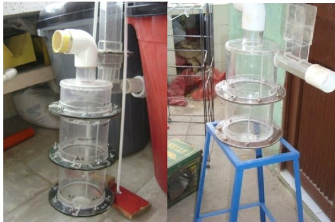
El proceso de manipulación del acrílico en caliente y basado en moldes de madera y plásticos conlleva a la culminación de la construcción de los dispositivos hidráulicos de flujo centrífugo; en la figura 49 se puede apreciar el canal curvo con su disposición final.
