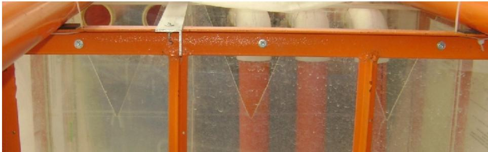
En la figura 65 podemos apreciar el funcionamiento de un vertedero triangular, se dispuso de un vertedero de pared delgada con un acrílico de 3mm de espesor.
