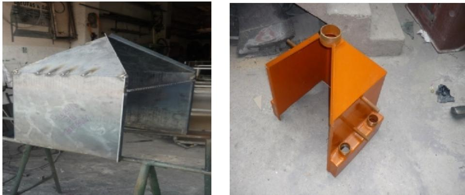
Una vez terminado el trabajo de doblado se lleva las partes al taller de soldadura para proceder al ensamblaje de las mismas, se requiere al igual que el tanque desarenador, recubrir esta tolva con material anticorrosivo, para protegerla de posibles problemas causados por la corrosión, posteriormente se realiza el trabajo de acabado y pintura para brindar una estructura con una buena apariencia y condiciones optimas.
