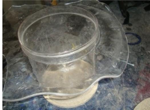
En la Figura 48 se indica el hidrociclón terminado con su base de soporte.
