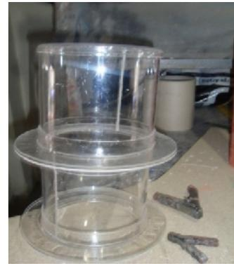
Fue necesario realizar moldes (ver Figura 46) para elaborar ángulos de forma circular diámetro de 15 cm para luego ser pegados en el hidrociclón circular para que sirvan de conexión entre tanques y formar diferentes alturas para el hidrociclón (ver Figura 47), a estos ángulos se les realizó ocho perforaciones a cada uno para apretar entre ángulos con tornillos de 1/16" logrando un cello hermético.
