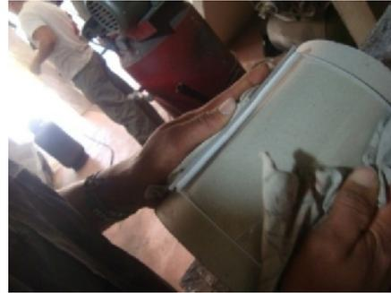
**Figura 44. Pegado del acrílico con inyección.**
