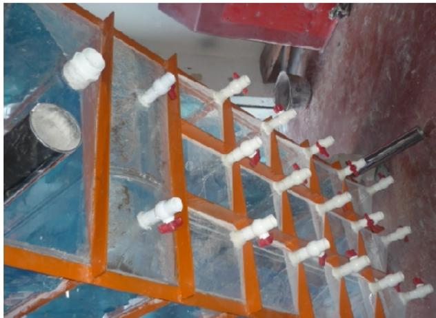
**Zona de salida:** puede ser en canaleta con vertederos u orificios, para el caso especial se adopta una tubería PVC, dispuesta a lo largo de la zona de sedimentación con las modificaciones pertinentes para simular el canal de
