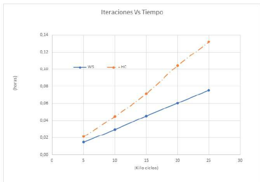
Figura 4. Relación tiempo de ejecución vs ciclos de interacciones del Código versión CUDA de las computadoras WS y HC.
