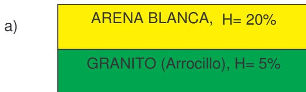
Antes de realizar un análisis de las tomografías es necesario precisar que en estas superposiciones se encuentran los dos tipos de suelo; el Granito (Arrocillo), y la Arena Blanca con humedades del 5% y 20% respectivamente.
