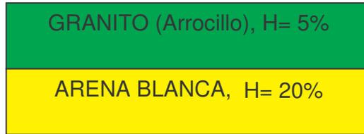
En esta segunda superposición (Fig. 16), la arena blanca se ubica en la parte inferior y en la parte superior el Granito. Aunque el comportamiento de la Arena, demarca una menor resistividad; se distingue que en los dos tipos de suelos, las resistividades son proporcionales en casi todo el perfil y están entre 222 – 546 ohm-m.
