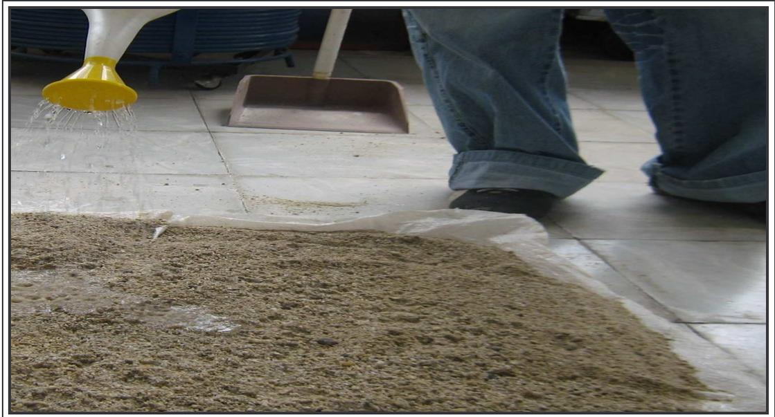
Luego se revolvió el material y se lo vació al tanque, (foto 10); utilizando una bandeja de aluminio mediana, a una altura de 20 cm. y sin compactarlo.
