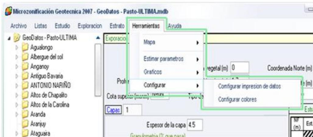
**Configurar impresión de datos:** permite al usuario configurar el orden en que se imprimirán los datos de cada exploración mediante el formulario de la figura 23. Los datos se imprimirán en el orden en que el usuario lo indique pero los datos que no alcancen en la hoja ya sea oficio o carta, no se imprimirán.
