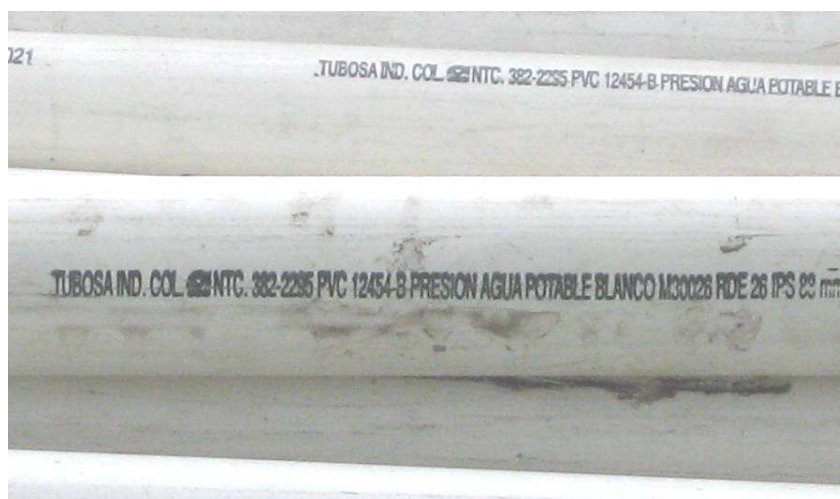
Figura No 87. Tubería pvc 3" RDE 26 Uz
