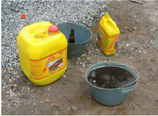
Figura No 63. Impermeabilizante para mezcla de concreto
