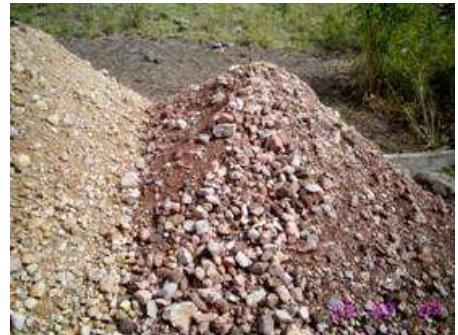
Figura No 38. Material con sobretamaños que se hizo retirar del sitio
