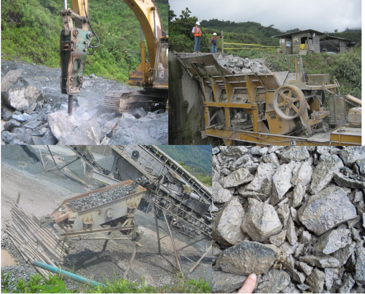
Figura No III.2. Proceso planta de trituración (fragmentación, trituración y selección).
