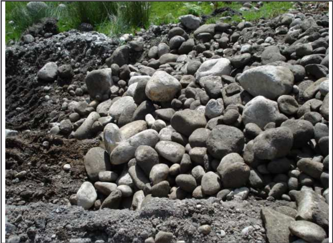
Figura 22. Material para pedraplén proveniente del río San Pedro
