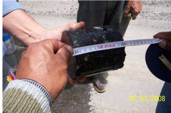
Foto 21. Comprobación de espesor y ancho de carpeta
