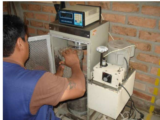
Foto 158. Ensayo de compresión.
