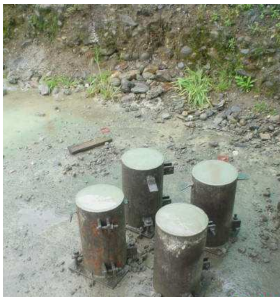
Foto 5. Toma de muestras para ensayo de compresión
