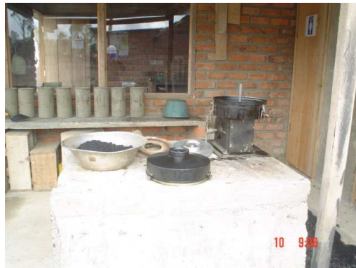
Foto 164. Ensayo de cont. asfalto.
