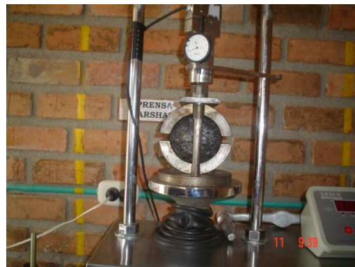
Foto 170. Ensayo a compresión
