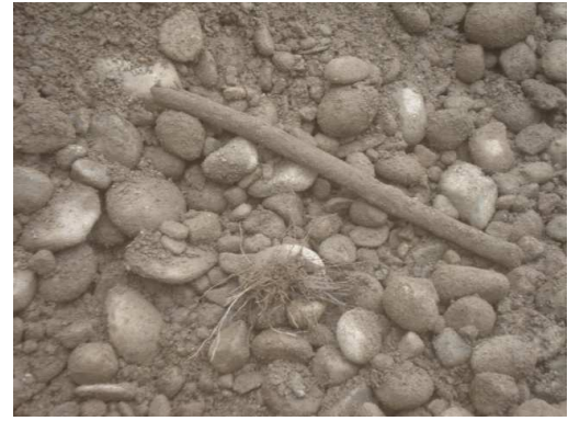
Contaminación con material vegetal.
