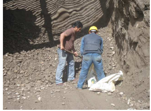
Toma de muestra para laboratorio de granulometría el cual es tomado de la parte donde se evidencia la menor cantidad de partículas grandes.
