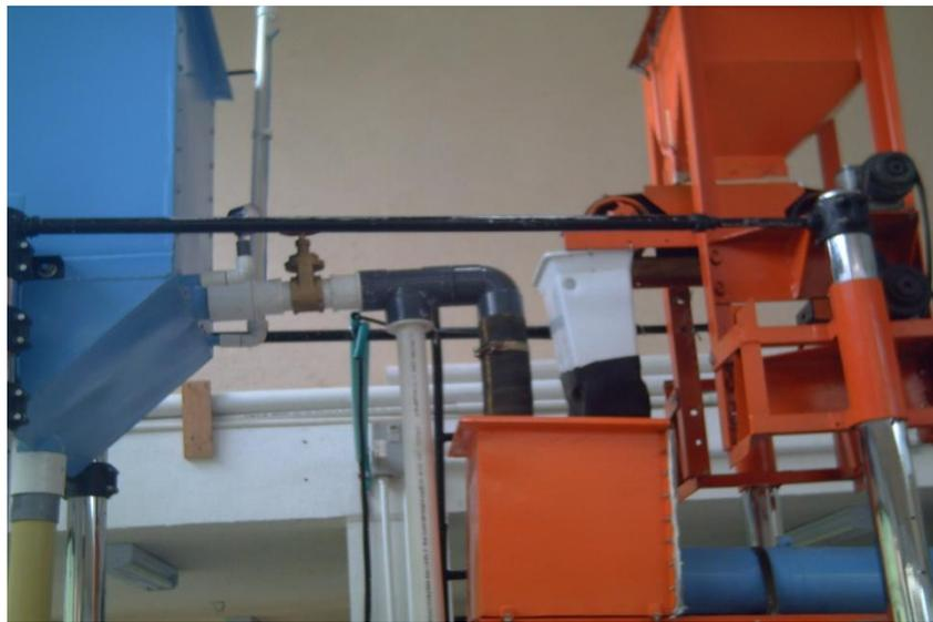
**2.1.2 Adecuación de estructura existente.** Como se tenía planificado en el anteproyecto de este trabajo de grado se cambio las abrazaderas plásticas que habían sido utilizadas como soportes y guía del canal por unas abrazaderas metálicas hechas en lamina galvanizada de  $e= 3/16$ " estas nuevas abrazaderas
