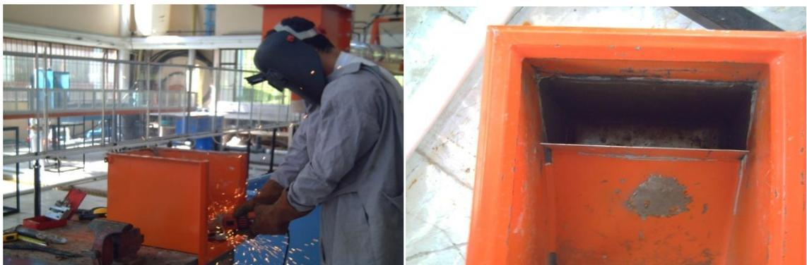
**Figura 14. Adaptación niple para desalojar el agua del tanque**
