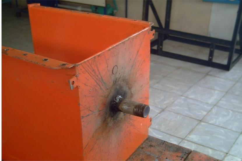
Debido a la modificación del tanque inclinado se procedió a realizar ajustes en la tubería que hace la entrega de agua en dicho tanque
