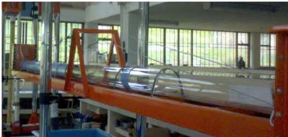
Se decidió cortar el tubo de PVC dejando 10 cm desde la base y se acopla los dos tubos de vidrio consecutivamente y después de esto se instala el tubo de PVC para llegar a los 6 metros y evacuar el agua al desarenador.
