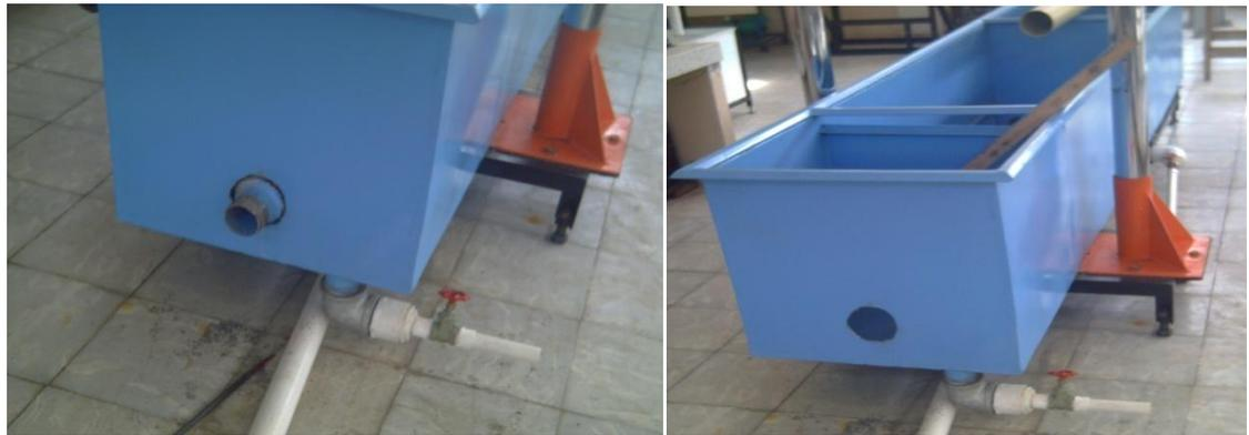
Después de perforar la lamina de salida en el desarenador se limó y se pintó con pintura anticorrosiva para proceder a instalar un accesorio macho y una hembra de 4" como parte de la conducción al tanque de reservorio, indicado así en la figura 10 y 11 respectivamente.
