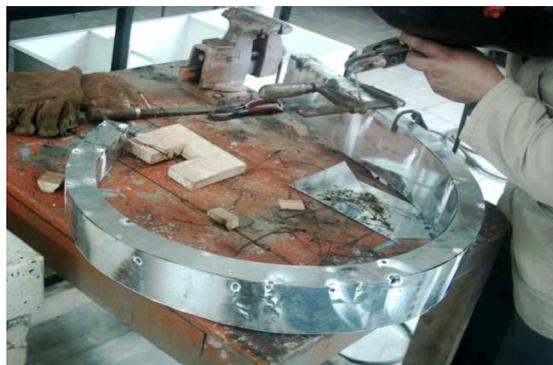
Fotografía 3-1 Construcción del modelo experimental en lámina.
