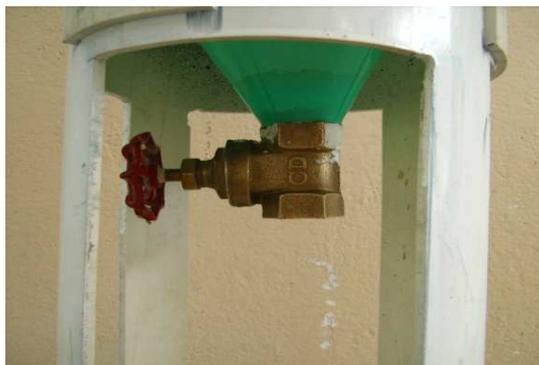
**Fotografía 4-1. Válvula de cierre del dosificador de sedimentos**
