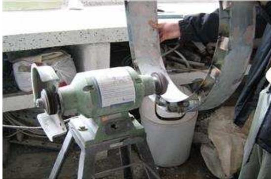
**Fotografía 3-2. Etapa de masillado y pulido del modelo experimental en lámina**
