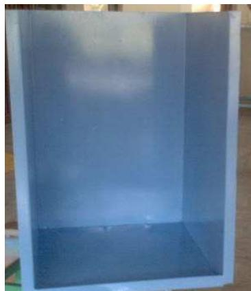
**3.3.2 Tanque externo.** Su alto es de 0.76 m, ancho de 0.6 m y largo de 0.6 m. y se ubica a una altura de 2.3 m. Tiene algunos aditamentos como son un niple de 3 pulgadas que sirve como desagüe y dos niples de 1 pulgada que sirven para medir el nivel del agua en el tanque interno por medio de un manómetro y un tubo de vidrio.
