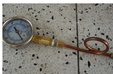
**3.7.2 Manómetro en tanque elevado.** Este manómetro se ubica en el tanque elevado de cabeza constante y variable para tomar lectura de la variación del nivel de agua del tanque. La lectura se puede realizar en onzas sobre pulgada cuadrada (OZ/in<sup>2</sup>) o pies de agua (inH<sub>2</sub>O).
