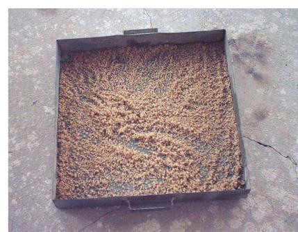
Foto 64. Ensayo del cono para verificar estado SSS
