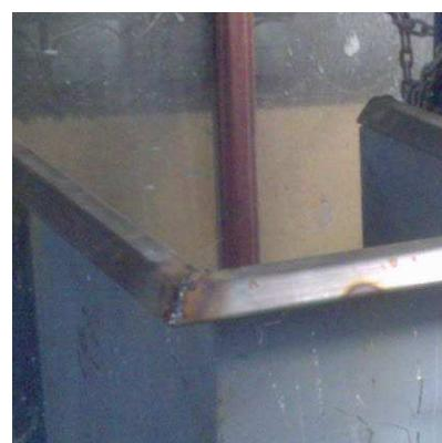
**3.2.3 Construcción de viga de soporte.** La viga para soporte del canal se construyó con la unión de diferentes tipos de ángulo; como ejes externos se utilizó ángulos en C unidos entre sí por ángulos rectangulares de longitud 0.19 m espaciados cada 0.5 m. La unión de los ángulos por medio de soldadura lo realizó personal especializado.
