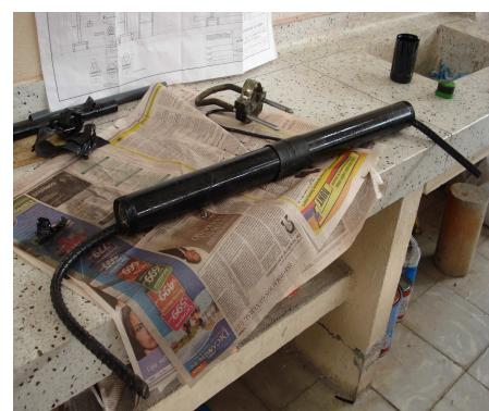
El gancho inferior del diferencial sujeta un tubo hueco de 44.5 cm por donde pasa una cadena la cual se asegura con tornillos en las abrazaderas plásticas que van sobre los tubos cromados y que a su vez están atornilladas a la viga de soporte, esto con el fin de levantar la viga de forma nivelada.
