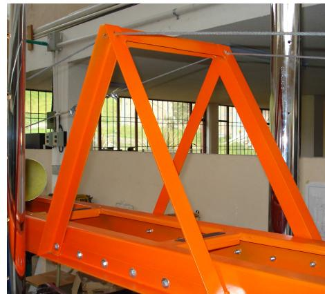
**Tensores:** Se desplegaron un par de tensores con el fin de evitar la deflexión presentada sobre la viga de soporte del canal y así mantenerla nivelada. Estos tensores están hechos en acero para resistir alta carga a tensión.
