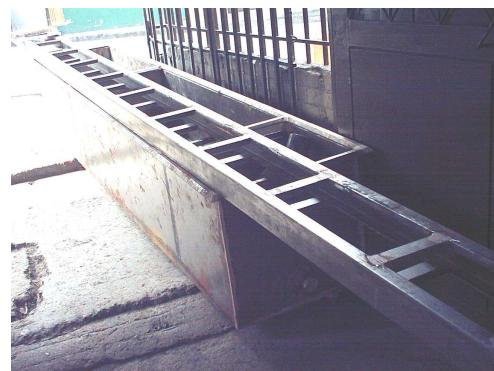
**3.2.4 Acabados de tanques y desarenador.** Se macilla y se lija con el fin de obtener un buen acabado. Posteriormente se pinta con anticorrosivo para evitar futuros problemas de corrosión ya que los tanques se encontrarán en constante contacto con el agua.
