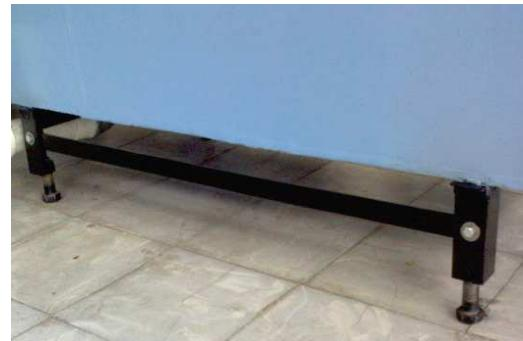
**3.4.4 Abrazaderas plásticas y metálicas.** Son las que soportan el peso de los tanques y lo transmiten hacia los tubos niquelados. Permiten la elevación y el descenso de los tanques externo e interno además del dosificador de sólidos y permiten variar el nivel de la viga de soporte del canal con el fin de realizar ensayos de mezcla agua – sedimento variando su pendiente.
