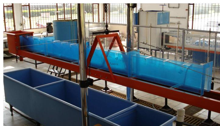
**3.8.5 Construcción canal triangular.** Utilizando acrílico de 5 mm de espesor se cortan tres láminas rectangulares de (180 x 30) cm, dos formaran las paredes de los canales y la otra se utilizará para recortar secciones triangulares de (25 x 30) cm sobre las cuales se trazan las forma triangular.
