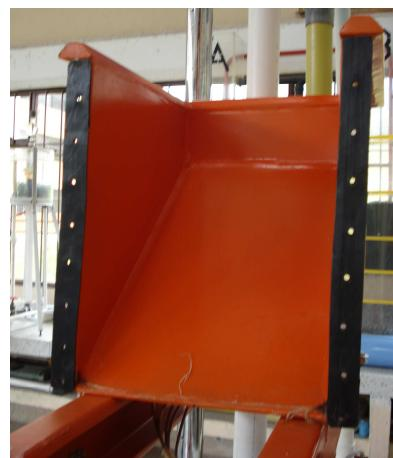
**3.3.6 Tanque disipador de energía.** Tiene un alto de 0.37 m, un ancho de 0.3 m y un largo de 0.39 m. Además tiene una tolva con un niple de 2.5 pulgadas que sirve como desagüe. Por el lado en el cual se introduce la viga para soporte del canal se hizo un hueco de ancho igual a 0.2 m y alto de 0.26 m con el fin de introducir parte del canal en este tanque para realizar la descarga.
