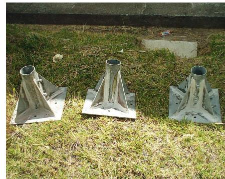
**3.4.3 Plataformas de nivelación.** Son las bases que soportan todo el montaje y permiten la nivelación total de este a través de tornillos. Se construyeron en ángulos estructurales en “L” de 2 pulgadas y fueron pintadas de color negro. Se realizaron las siguientes bases:
