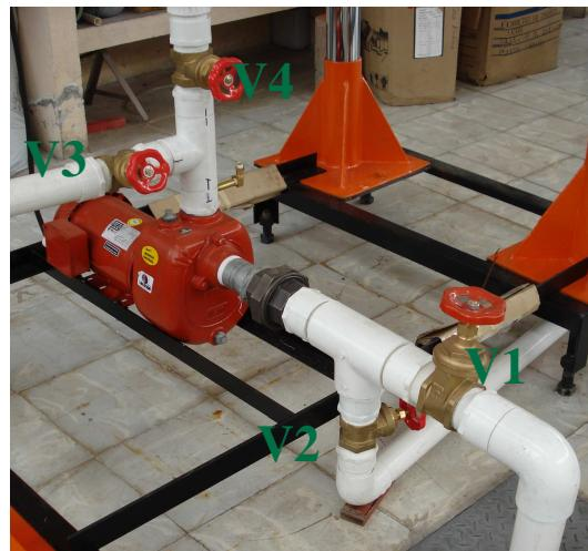
**3.5.4 Motobomba.** Es necesario precisar que este equipo es autocebante y tiene una potencia de 3 Hp o 2.2 Kw y su capacidad de bombeo es de 10 lps. Toma el agua de un tanque de laboratorio o desde el desarenador y la sube al tanque para almacenamiento de cabeza constante o tanque interno o la envía directamente hacia el canal. Esta motobomba trabaja a 3430 rpm, con un voltaje de 220 / 440 voltios, su conexión es trifásica y su eficiencia es del 84%.
