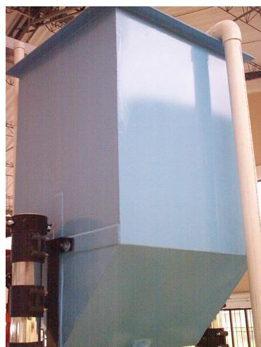
**3.3.3 Dosificador de sólidos.** El equipo esta conformado por una tolva por donde se vierte el sedimento y una compuerta que regula la abertura para la salida del material, el sedimento se transporta por una banda que gira a través de un motor que esta conectado a un voltaje de 220 voltios. El dosificador se ubica a una altura de 2.23 m.
