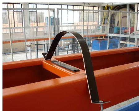
**3.8.3 Canal rectangular y triangular.** Los canales se construyen con láminas de acrílico y láminas metálicas y se realizan en tres tramos facilitando el montaje y desmontaje sobre la viga.
