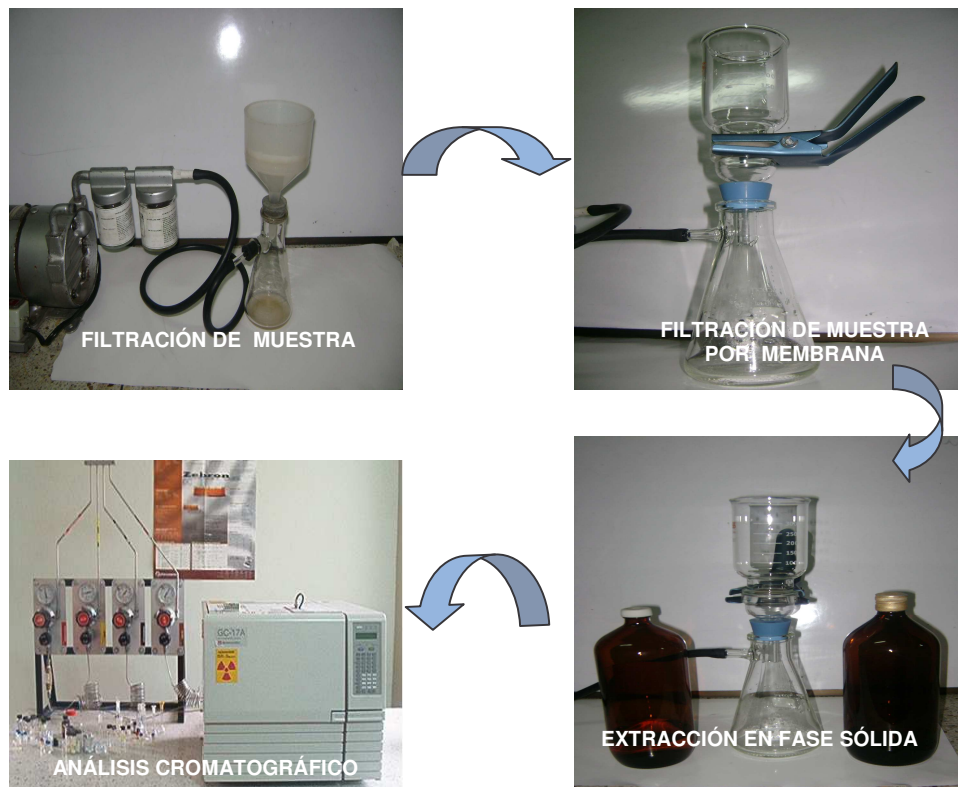
Figura 6. Esquema extracción en fase sólida (EFS).
