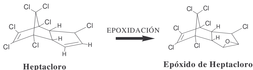
Figura 18. Reacción de epoxidación del heptacloro [25].
