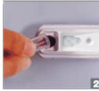
4. Tapar el tubo de ensayo y mezclarlo a fondo invirtiéndolo entre 3 y 5 veces.
