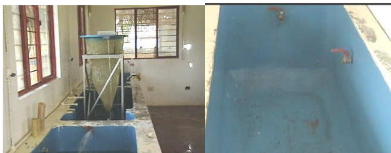
En el Laboratorio de Larvicultura y Productividad Primaria de la Universidad de Nariño (Figura 6) se montó un sistema de recirculación el cual constó de un acuario reservorio con capacidad de 200 l, un biofiltro con espuma y guata, doce bandejas experimentales, un termómetro, dos termostatos con capacidad de 40 galones cada uno y una bomba
