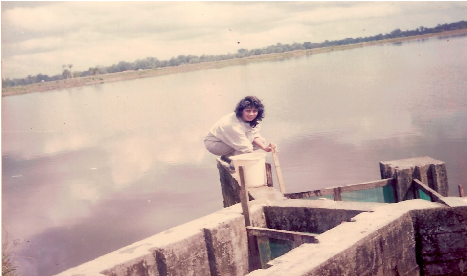
Figura 3. Toma de la muestra con el tubo muestreador en la compuerta de entrada
