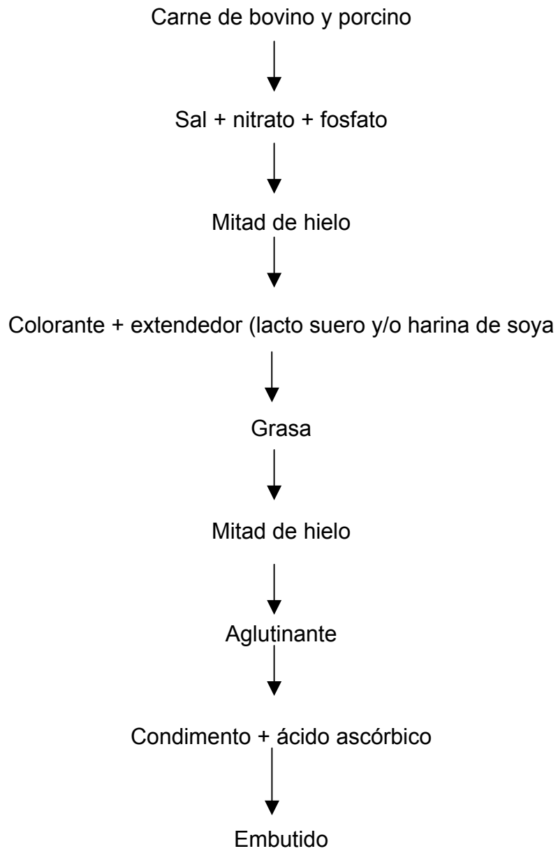
Figura 3. Diagrama de flujo para proceso en cutter del salchichón corriente
