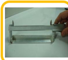
Si no se tiene a la mano la norma DIN, el calculo hay que realizarlo utilizando la geometria, midiendo el area del cangilon con el flexometro o calibrador y multiplicandola por la longitud del cangilon obteniendo el volumen en  $\text{m}^3$ .
