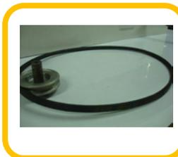
**Banda o correas:** elemento flexible capaz de transmitir potencia que asienta en forma ajustada sobre un conjunto de poleas; pueden ser planas, en V y dentadas. Son fabricadas en cuero, caucho, cables de acero impregnados de caucho y lona.
