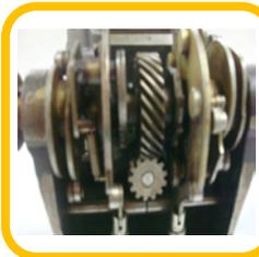
**Reductor de velocidad:** sistema conformado por un tornillo sin fin conectado a un engranaje recto o helicoidal, quien reduce la velocidad del sistema gracias al número de dientes que se colocan en contacto con el tornillo sin fin. Tiene una relación de velocidad fija.
