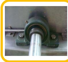
**Chumacera:** son cojinetes o valineras, montadas en una armazón de acero o hierro fundido lo cual facilita la instalación del sistemas de transmisión de potencia directamente al armazón de la maquina mediante tornillos.
