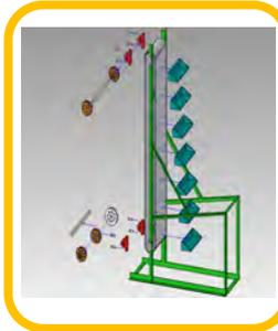
**Elevador de cangilones:** Los elevadores de cangilones son dispositivos que transportan el material elevándolo verticalmente o próximos a la vertical, poseen un mecanismo para el transporte del material constituido por recipientes (Cangilones) unidos a cadenas o bandas, acondicionados al material a transportar o el tipo de elevador.
