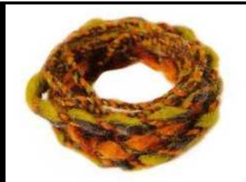
Otro ejemplo de poliamidas es el lilión, que, con frecuencia, se utilizan en copos que se mezclan con lana y algodón en hilados mixtos. El resultado son fibras más reforzadas. Una de las propiedades características de las poliamidas es su elevado grado de resistencia al rompimiento.
