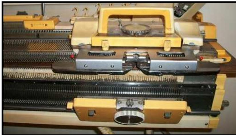
**Tipo de tejido de las maquinas.** El tipo de tejido puede ser de punto grueso y de punto delgado, que viene definido por el tipo de galga de cada máquina. La galga determina la finura de las maquinas de tejido, que generalmente está dada por la cantidad de agujas que se alinean en un fontura en una pulgada de longitud. Por lo tanto a mayor número de galga el tejido es más fino. Se utilizaran las maquinas con los dos tipos de tejido.
