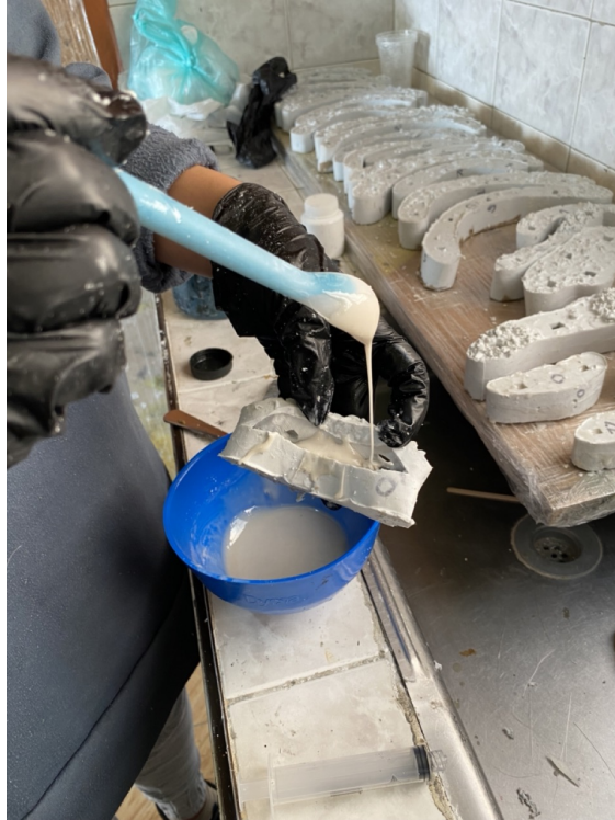
Figura 5.2.8: Llenado de los moldes de caucho con la mezcla compuesta de resina y carbonato de calcio.
