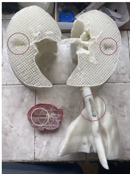
Figura 5.3.1: Perforaciones diseñadas para alojar los dosímetros destinados a pulmones, tráquea y corazón en las áreas señaladas.
