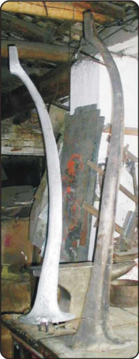
**Figura 74. Fundición en aluminio**
