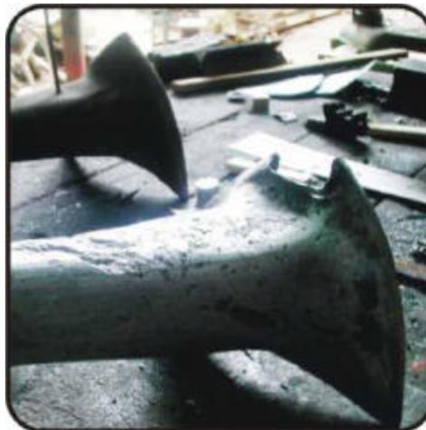
**Figura 73. Modelo en balsa y su respectiva fundición**
