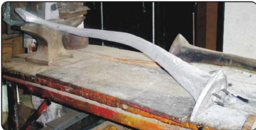
En la base del elemento, se pusieron unos pines provisionales para su fundición al concreto.
