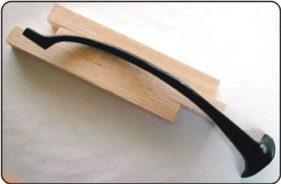
Como se muestra en la figura 67 se hizo una experimentación con un modelo de madera de balsa a escala, en el cual se siguió la forma descrita en el plano. El objetivo de este modelo, era probar la modelación de la forma tridimensional, a partir de la forma en el plano bidimensional con todos sus pormenores.
