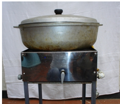
Figura 15. Estufa y paila para extracción de aceite
