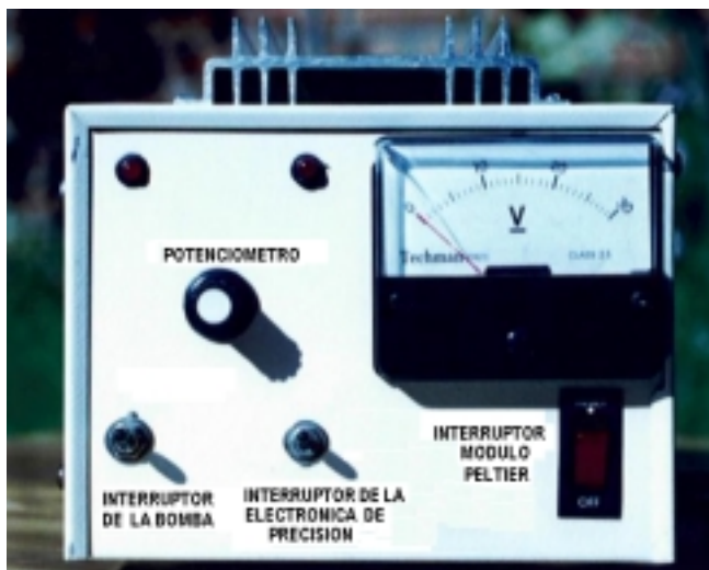
Figura 31. Fuente de poder construida para el proyecto de la cámara CCD. A la derecha se observa la parte posterior y superior. En la izquierda la parte frontal de la fuente.
