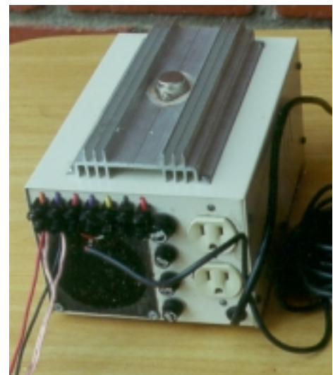
Figura 31. Fuente de poder construida para el proyecto de la cámara CCD. A la derecha se observa la parte posterior y superior. En la izquierda la parte frontal de la fuente.
