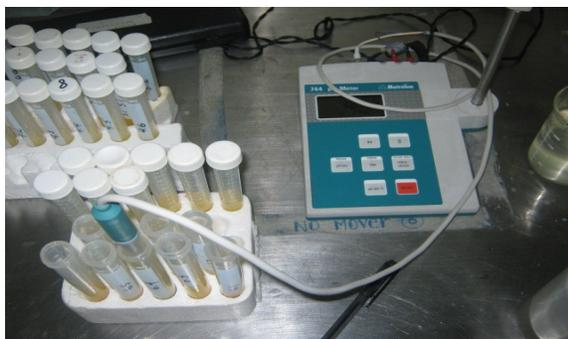
Figura 3. Medición con pH metro (744 Meter; Metrohm).
