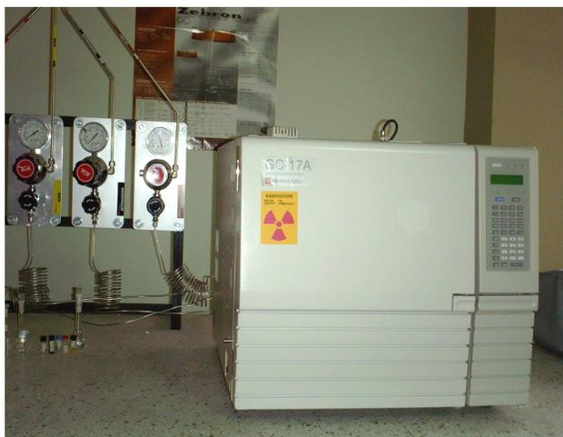
La identificación respectiva se llevo a cabo en un cromatógrafo de gases acoplado a un detector selectivo de masas (GC-MS) Shimadzu QP5000/Q5050A, con una biblioteca de espectros de masas WILEY-VCH. Columna DB5-MS (30m x 0.25mm, d.i., 0.25  $\mu$ m) con fase estacionaria ligeramente polar de 5% fenil poli (dimetilsiloxano). Con programación de temperatura de 60  $^{\circ}$ C (2 min) @ 6  $^{\circ}$ C/min hasta 90  $^{\circ}$ C (1 min).
