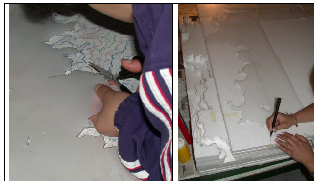
Figura 54. Fase de corte de moldes de curvas de nivel en papel calco (izquierda). Copiado de los moldes en las láminas de icopor (derecha).
