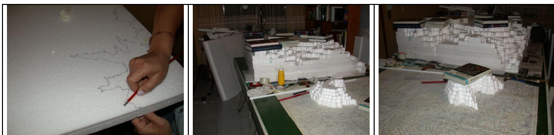
Figura 55. Fase constructiva de la maqueta. Corte de la curva copiada desde el molde al icopor (izquierda), pegado sucesivo de capas (centro y derecha)
