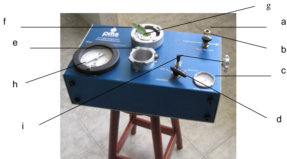
Foto 5. CÁMARA DE PRESIÓN CON SUS CORRESPONDIENTES PARTES
