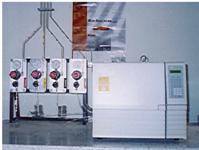
Figura 11. Cromatógrafo de gases con detector FID. Universidad de Nariño.
