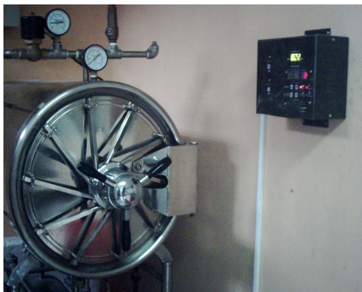
Figura 19. Montaje final del dispositivo de control de la autoclave.
