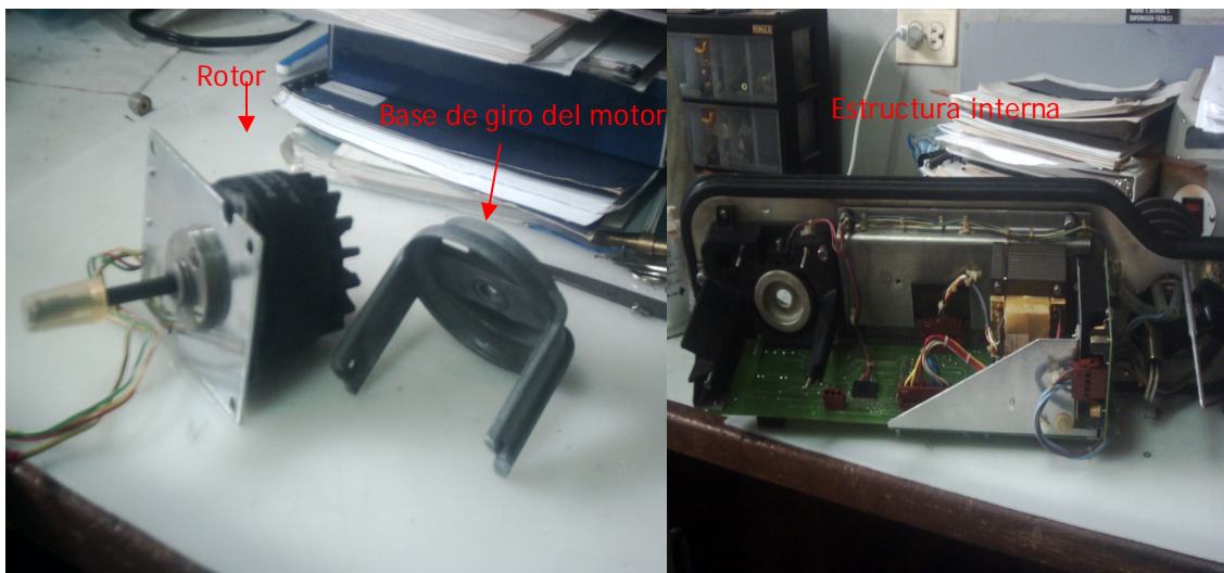
Figura 15. Motor de ventilación y presentación interna de la incubadora DRÄGER 8000 NC
