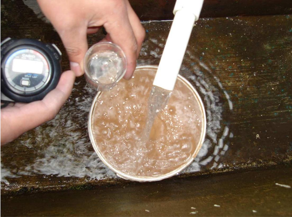
**Toma de muestra Prueba de Retención Hidráulica**
