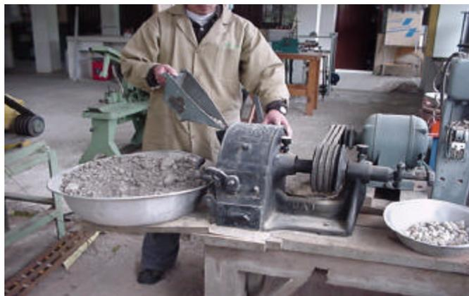
**3.6.2 Vidrio.** El primer paso para pulverizar este material fue romper las botellas de vidrio recicladas con una maceta con el fin facilitar el ingreso del vidrio en la jarra del molino de bolas; se utilizó este tipo de molino porque es muy práctico para moler materiales duros. El proceso de molienda emplea un período aproximado de 3 horas.
