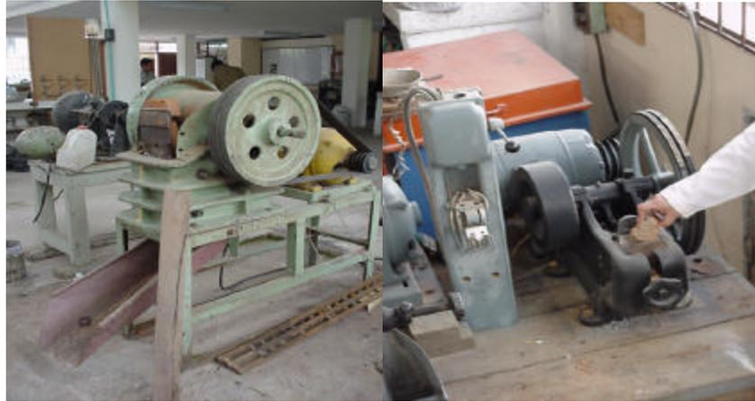
**3.5.3 Molino eléctrico de discos:** es un molino tipo industrial que sirve para disminuir el tamaño del grano de las arcillas y la chamota.
