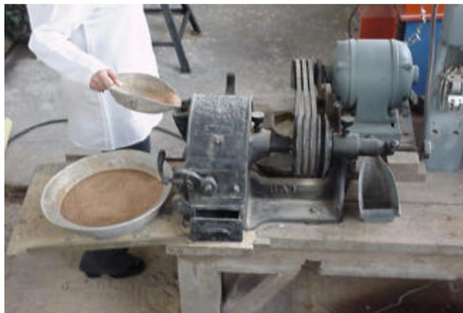
**3.5.4 Molino de bolas:** jarra de hierro con bolas del mismo material en su interior, que al girar permite moler o desmenuzar materiales secos. Debido a su peso y tamaño el molino es movido por un motor eléctrico.
