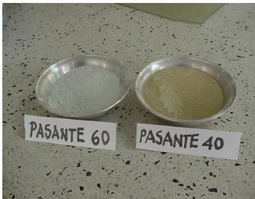
**3.6.3 Chamota.** Para la obtención de la chamota se aplicó el siguiente procedimiento: como primer paso se tomaron los escombros de ladrillos toletes y se pasaron por dos trituradoras mecánicas de quijadas para reducir su tamaño, finalmente los fragmentos se pasaron por un molino eléctrico de discos obteniendo así el polvo de ladrillo (chamota).
