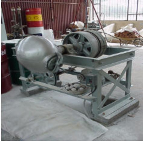
**3.5.5 Tamizador mecánico:** dispositivo mecánico de agitación y vibración que soporta un juego de tamices junto con un fondo y una tapa, vibran durante un tiempo dado. Se accionan con un motor eléctrico. Los tamices empleados para este caso fueron los No. 200, 100, 80, 60, 40, 16.
