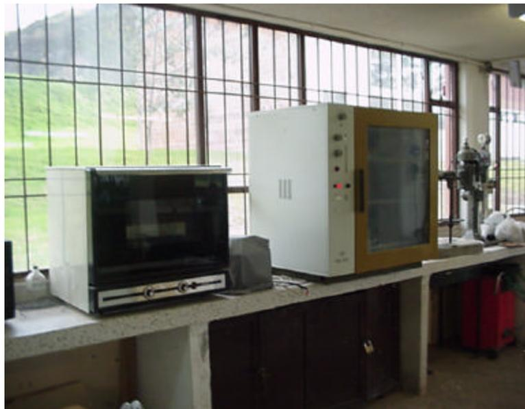
**3.5.11 Mufla de resistencia eléctrica:** En este artefacto se llevó a cabo el proceso de cocción de las probetas.
