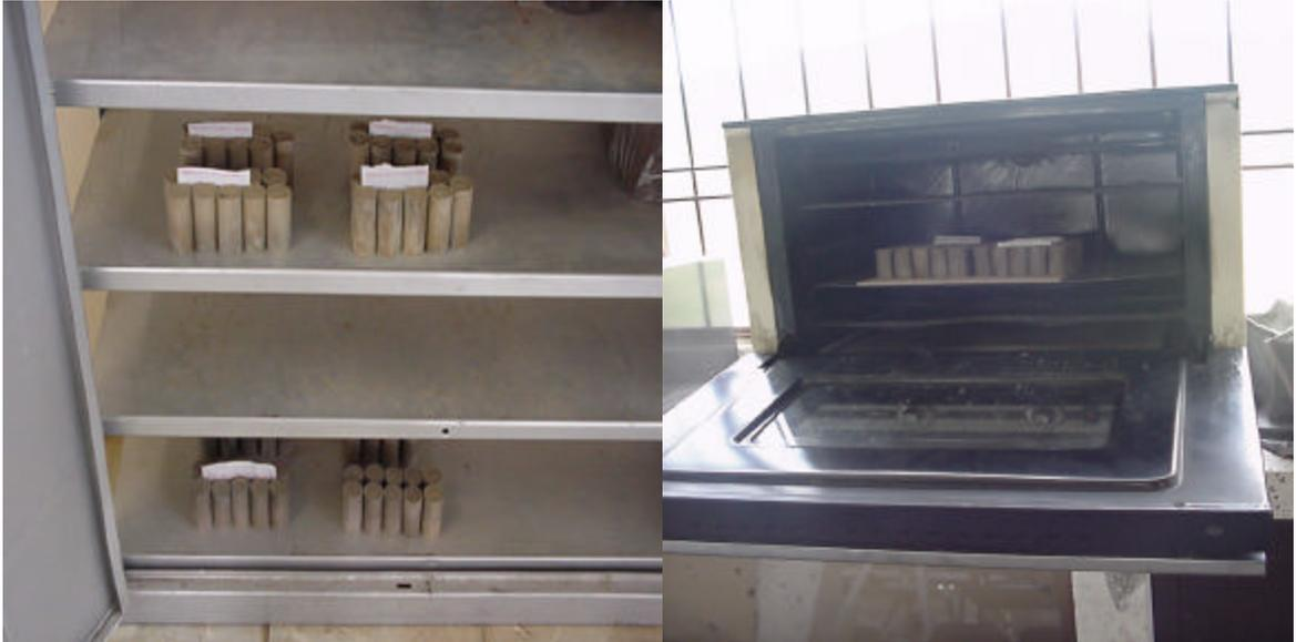
**3.6.7 Cocción** Cuando las probetas están secas son sometidas a un proceso de cocción, esto se lleva a cabo en hornos tipo muflas de resistencias eléctricas con control de temperatura. La cocción de las muestras se efectuó a  $950^{\circ}\text{C}$  y a  $1000^{\circ}\text{C}$ .
