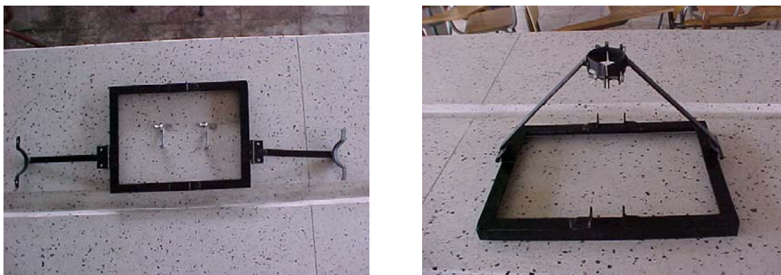
Figura 28. Base del Ariete Hidráulico
