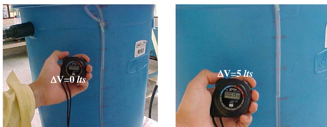
c.. Procedimiento para aforar caudal de entrada
