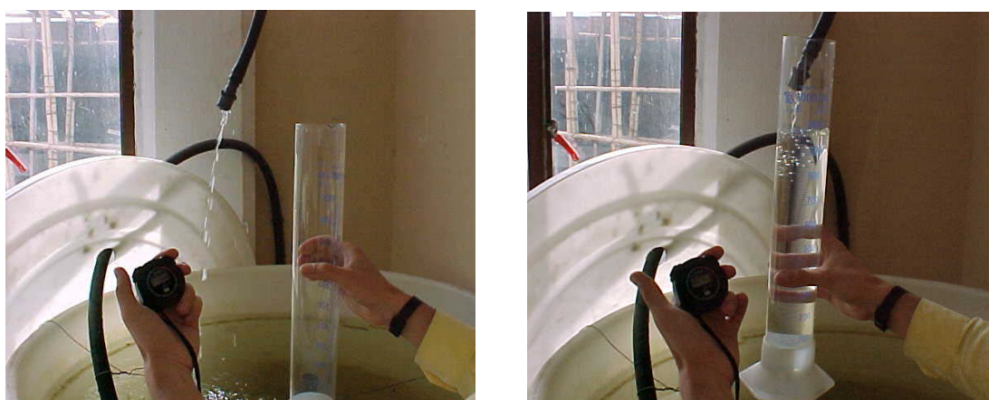
b. Procedimiento para aforar caudal de salida
