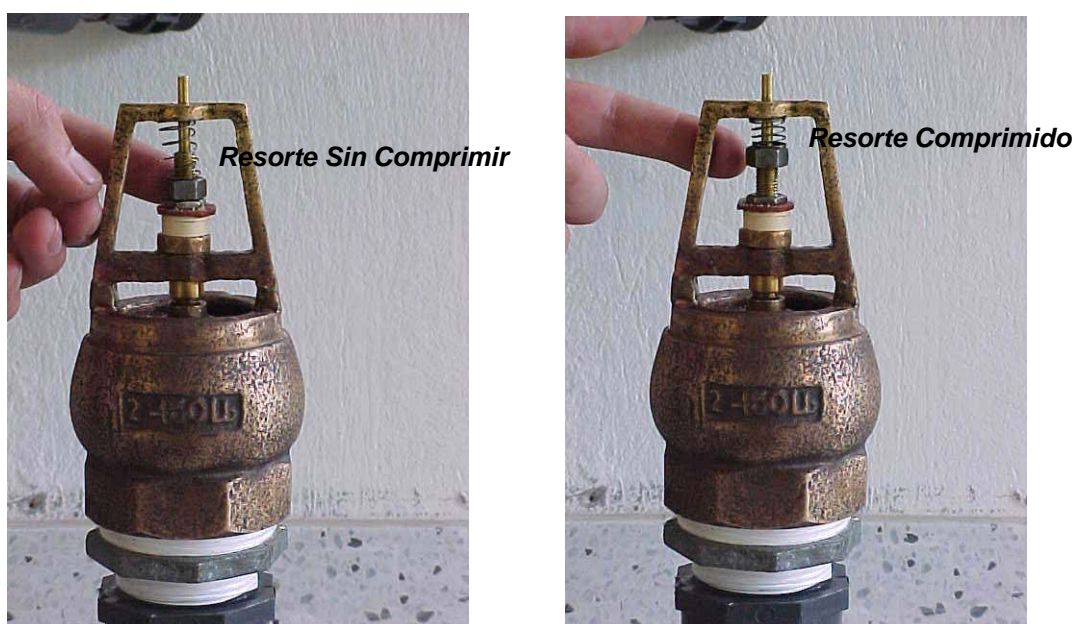
Figura 31. Calibración del Número de Golpes por Minuto
