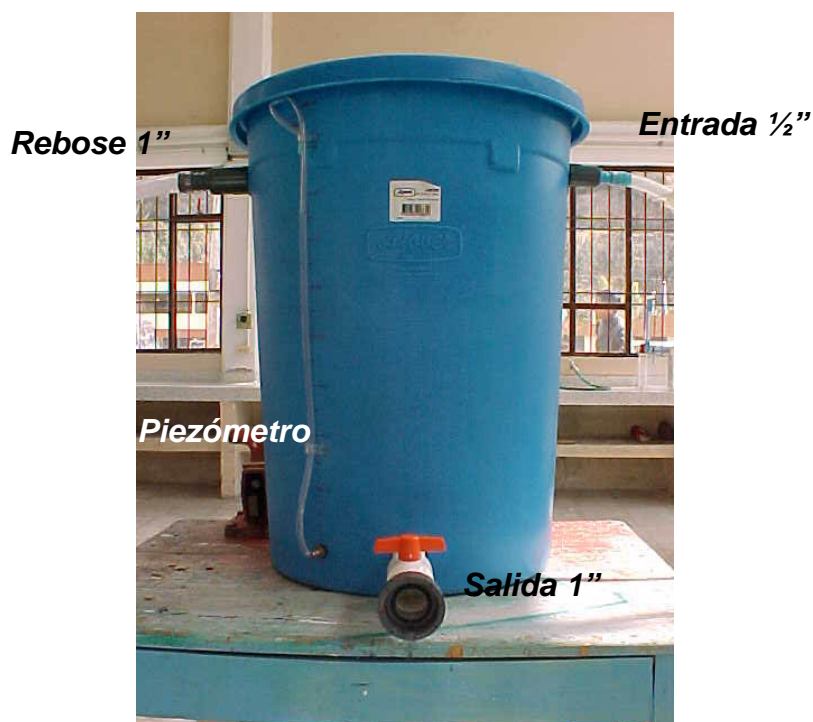
Figura 26. Tanque de Alimentación
