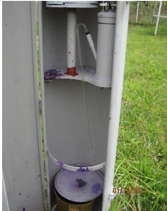
Figura 3. Pluviógrafo tubo de sifonaje (estación meteorológica “El Sauce”)
