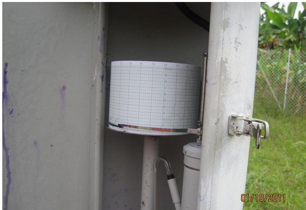
Figura 2. Pluviógrafo de tambor giratorio y pluma registradora (estación meteorológica “El sauce”).
