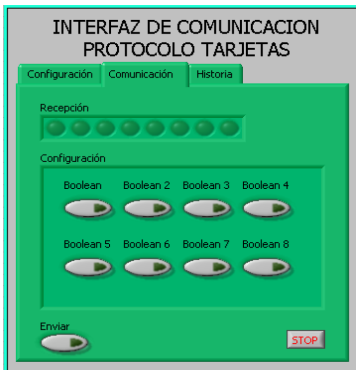
Figura 4. Panel frontal sub VI interfaz serial
