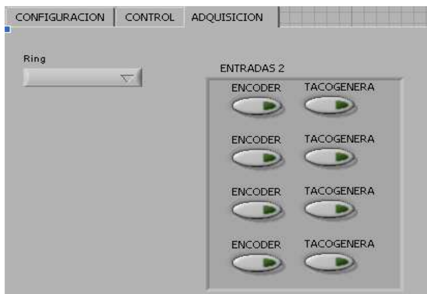
Figura 16. Panel frontal de adquisición de tarjeta de motores
