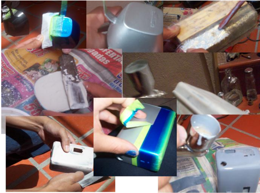
Figura 33 Construcción de los soportes con fibra de vidrio.
