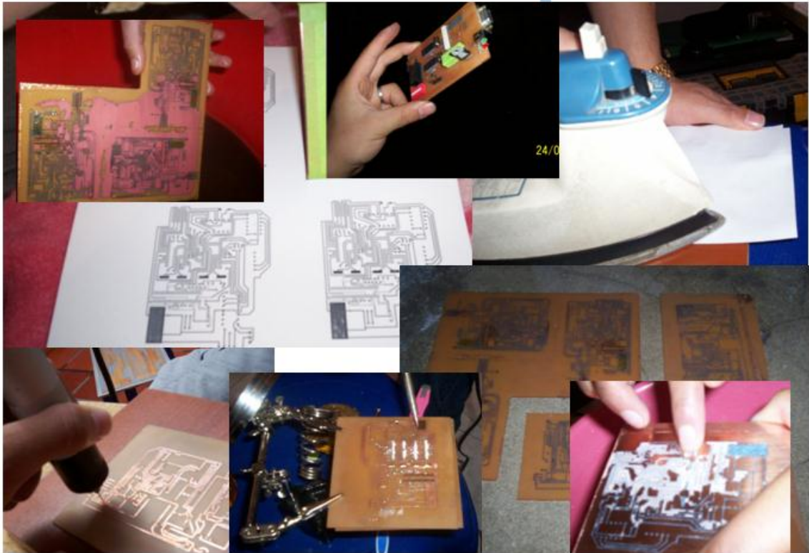
Figura 31 Construcción de las tarjetas de control.
