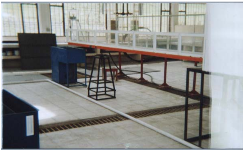
Figura 20. Patronamiento del vertedero rectangular
