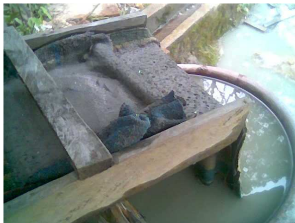
Figura 9. Paso de arenas finas a través de canalón
