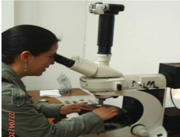
Figura 22. Microscopio petrográfico a luz reflejada Leica DMLP Pentax 10446175
