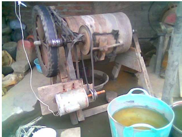
Figura 11. Proceso de remolienda en un molino de bolas
