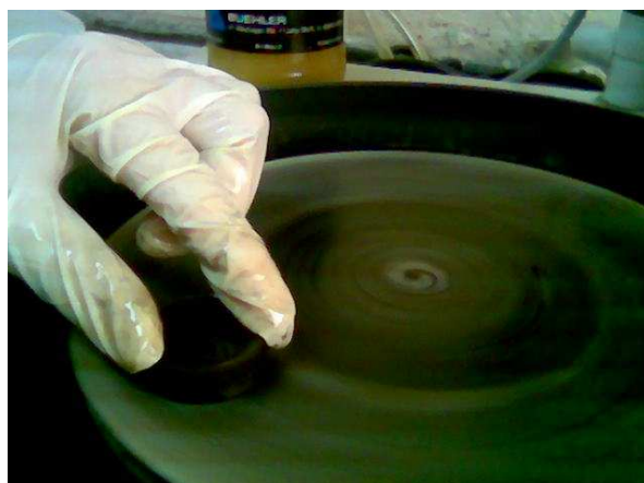
Figura 21. Pulimento de la resina para análisis con microscopio petrográfico a luz reflejada
