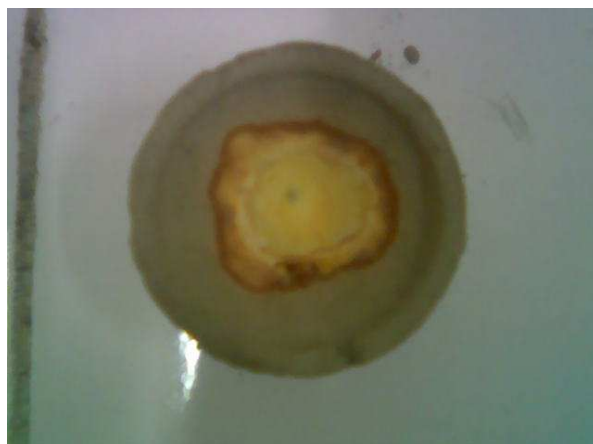
Figura 16. Doré obtenido en la copela
