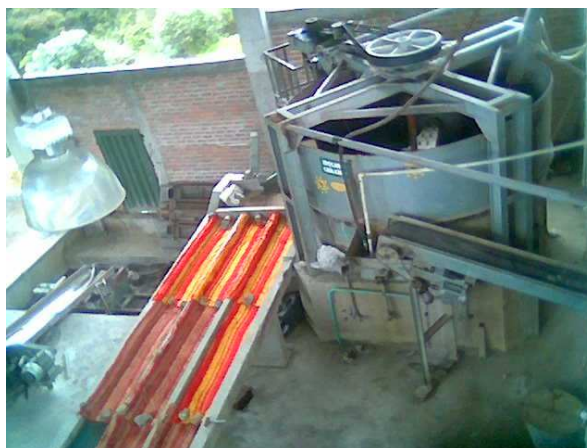
Figura 3. Planta piloto para procesamiento de minerales auríferos. La Llanada Nariño
