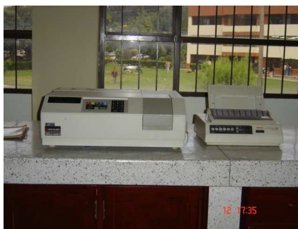
Figura 18. Espectrofotómetro UV-Vis Perkin-Elmer Lambda 11
