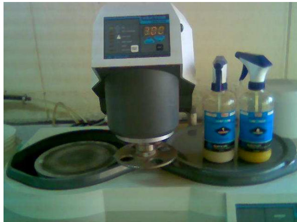
Figura 21. Pulimento de la resina para análisis con microscopio petrográfico a luz reflejada
