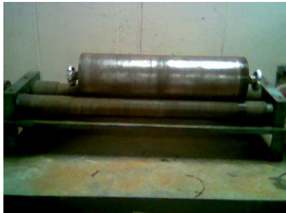
Figura 24. Molino de bolas ASEA, motor 60 Hz de 1730 rpm
