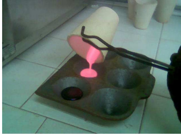
Figura 14. Traspaso de muestra fundida a lingotera cónica
