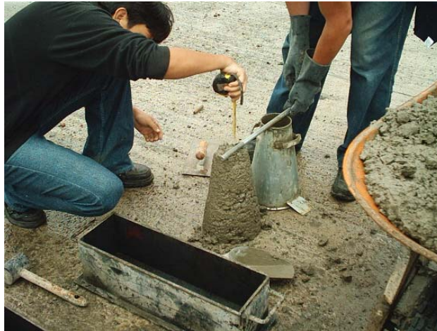
Figura 98. Ensayo de asentamiento
