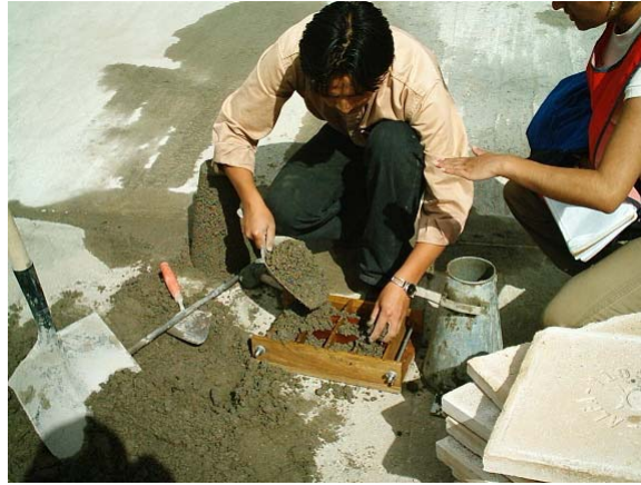
Figura 114. Ensayo de compresión para mortero
