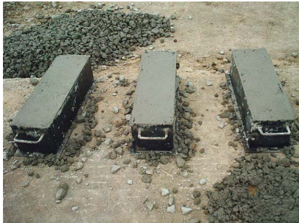
Figura 101. Viguetas para ensayo a Flexión
