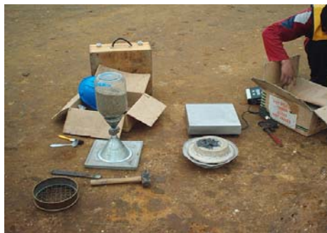
Figura 38. Ensayo “Cono y Arena”
