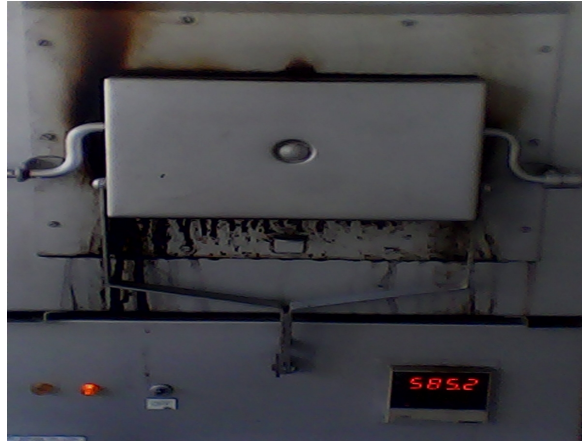
Figura 4. Mufla (Thermolab), Ciencias pecuarias, Universidad de Nariño*.
