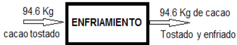
Figura 23. Balance de materia en enfriado
