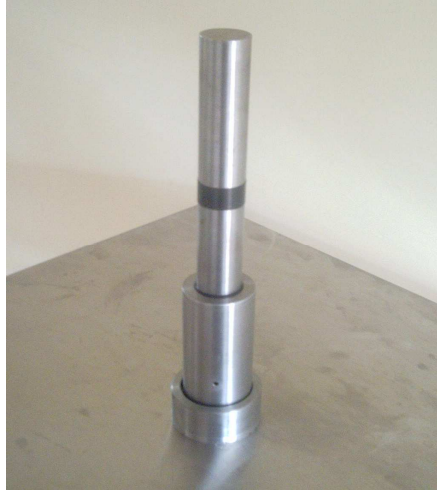
Figura 15. Sistema camisa-pistón a menor escala
