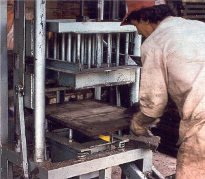
**Figura 36. Colocación del molde**
