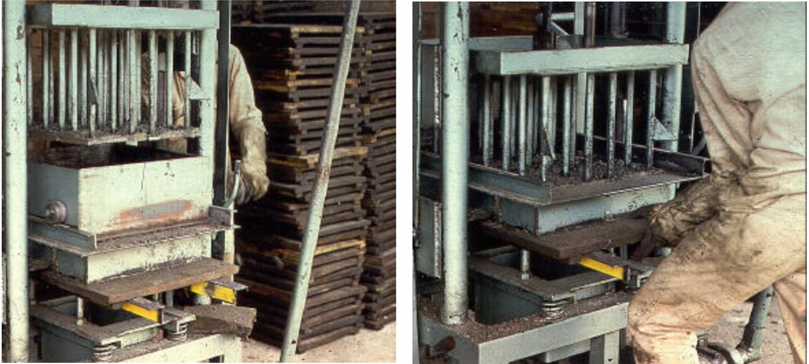
**Figura 39. Separación del molde y retiro de los adoquines**
