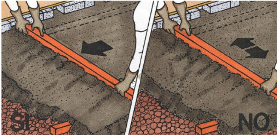
El enrasador debe ser rígido para que no se defleccione con su propio peso. Se debe tener cuidado que los obreros no se apoyen en él por dentro de los rieles, para evitar el mismo fenómeno. Será suficiente con una o dos pasadas, con un poco de arena sobrante, acumulada contra el enrasador, desplazándolo longitudinalmente, no en zigzag.
