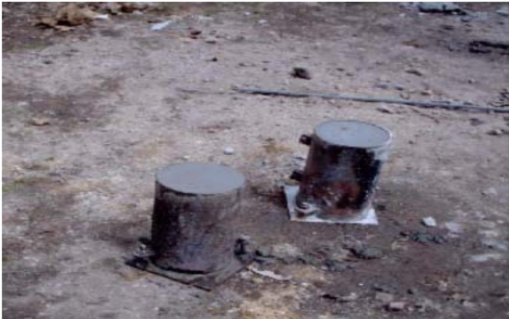
**Figura 30. Curado y protegido de las muestras, hasta un día antes de someterlas a pruebas de compresión para verificar la resistencia del concreto**
