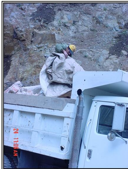
Figura 26. Volquetas con su respectiva cubierta
