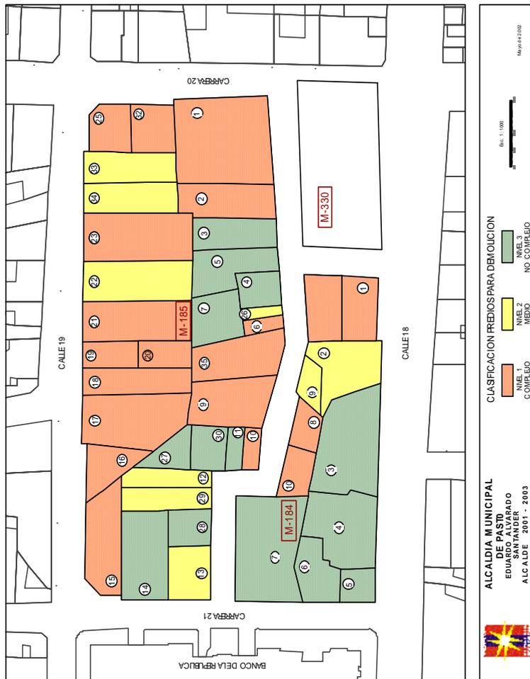
Figura 6. Plano Niveles de complejidad para demolición de predios
