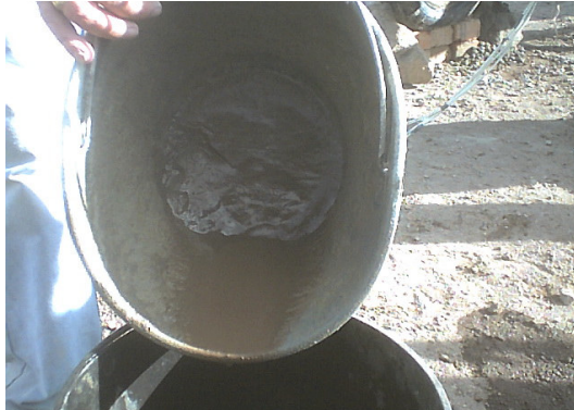
Figura 164. Materia orgánica encontrada en el agregado fino
