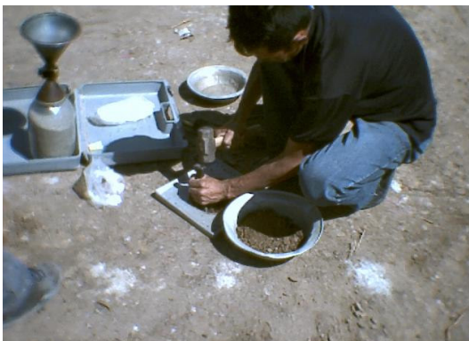
Figura 99. Ensayo del cono y la arena
