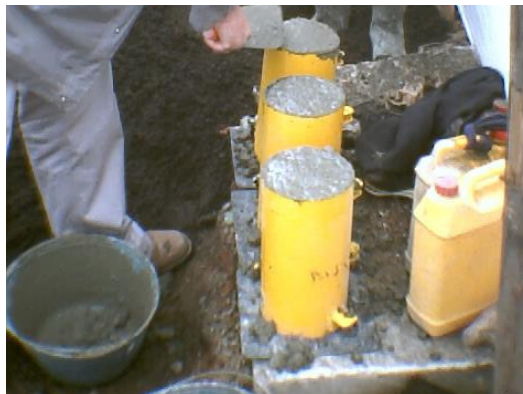
Figura 74. Fabricación de cilindros para el ensayo de compresión.
