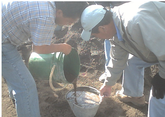
Figura 163. Lavado manual a una muestra de agregado fino
