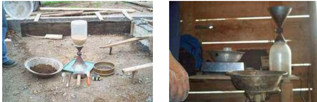
Figura 26. Peso unitario en el terreno, método del cono y arena
