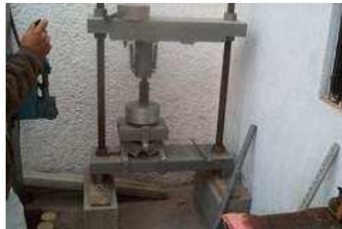
Figura 76. Toma de muestras para rotura de adoquines
