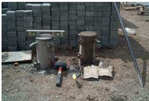
Figura 51. Toma de cilindros del concreto 3000psi para muros y base de la fuente
