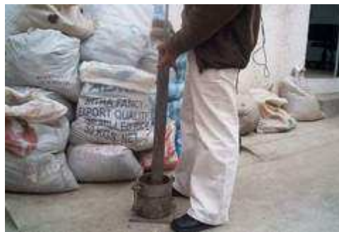
Figura 27. Ensayo de densidad del 90% del Proctor Modificado.
