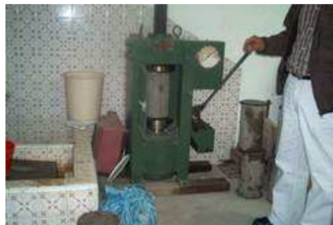
Figura 51. Toma de cilindros del concreto 3000psi para muros y base de la fuente
