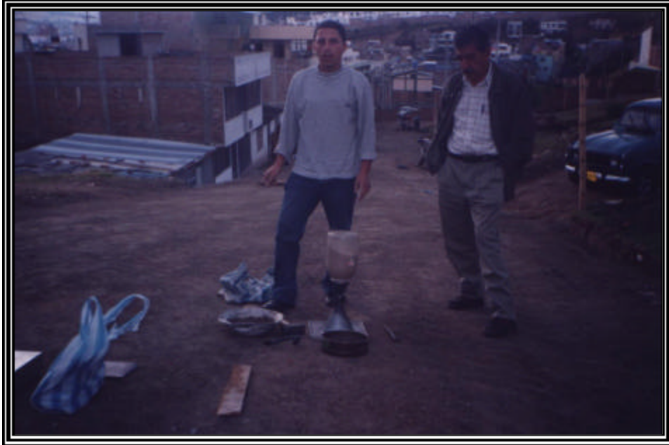
Figura 45. Ensayo cono y arena
