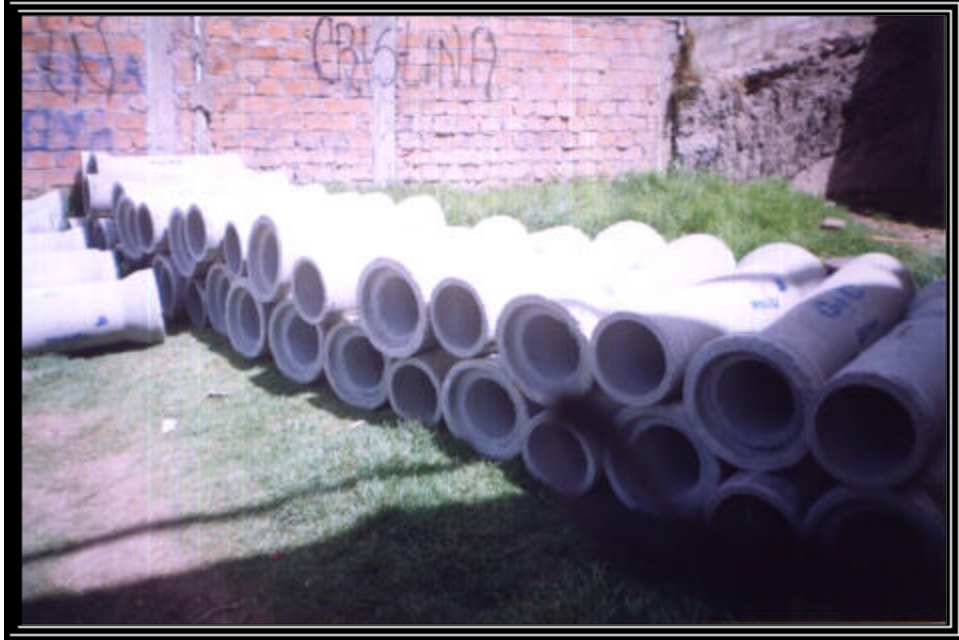
Figura 7. Tubería 10" G & C Prefabricados
