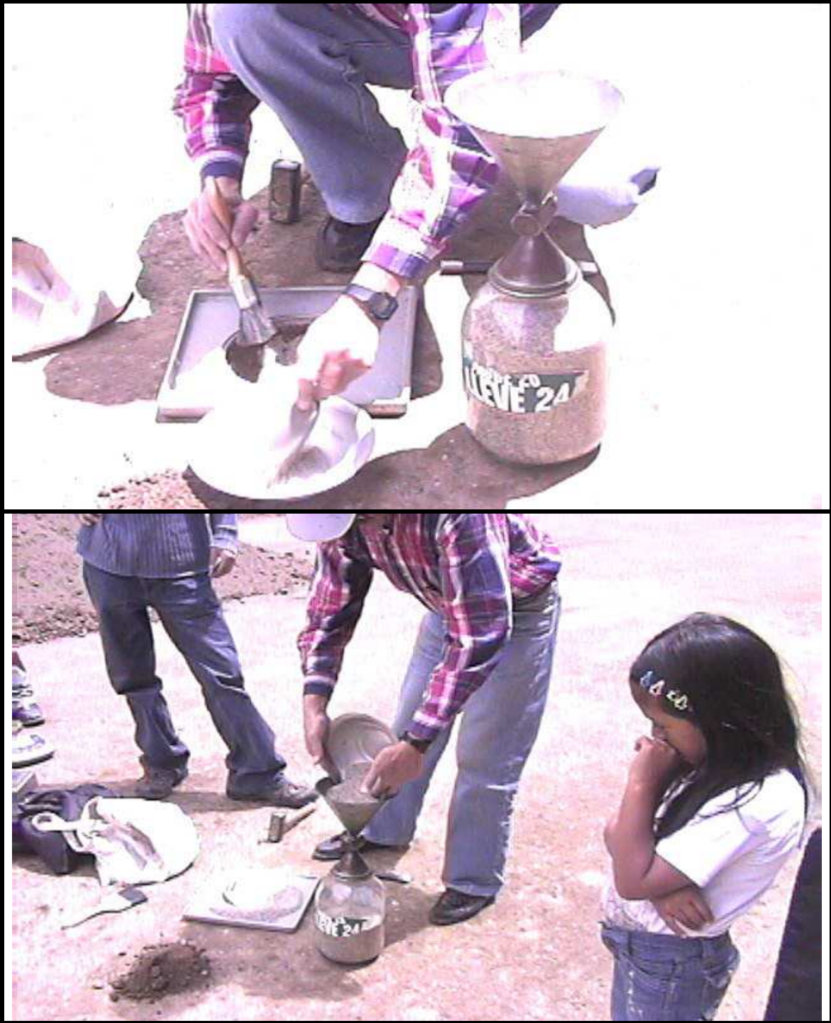
Figura 11. Ensayos de cono y arena en los bordes
