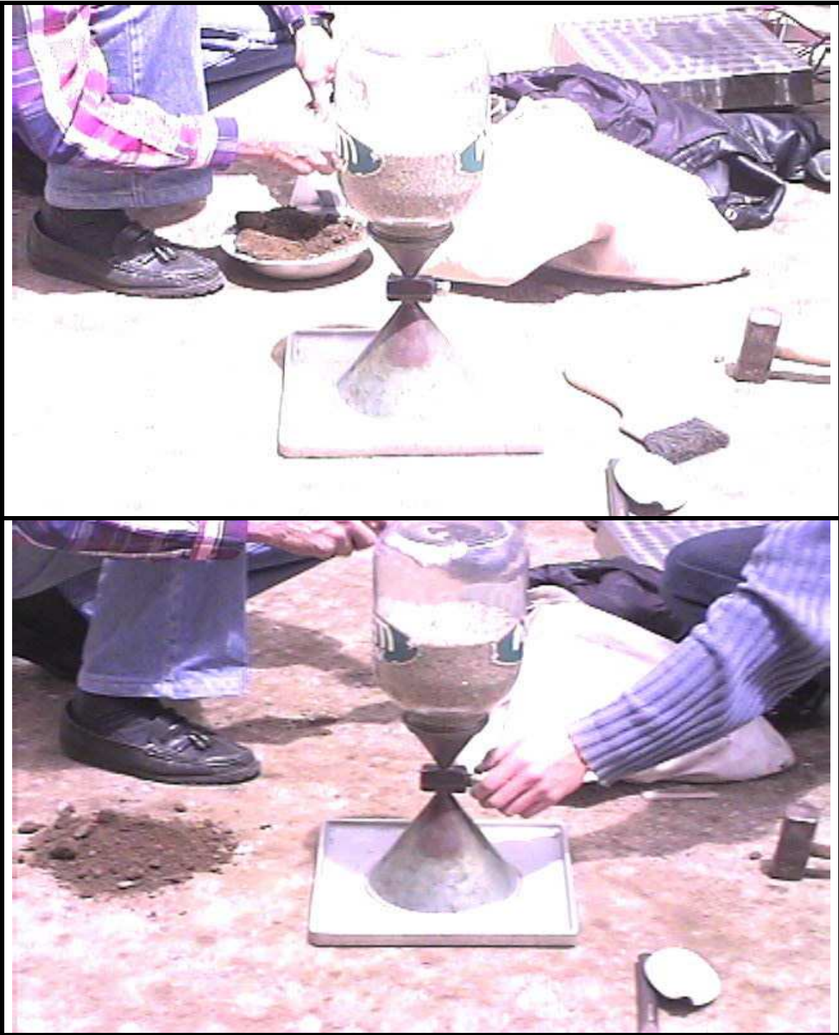
Figura10. Ensayo de cono y arena
