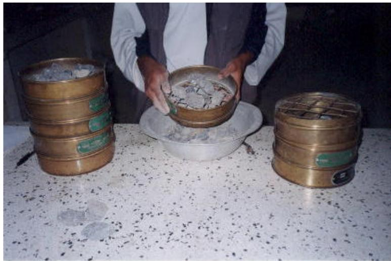
**Figura 123. Tamizado de agregado fino**
