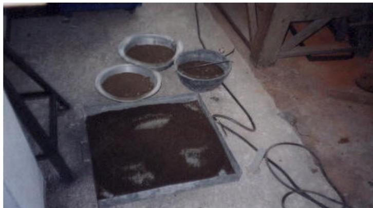
**Figura 126 Mezcla con agua del material de ensayo**
