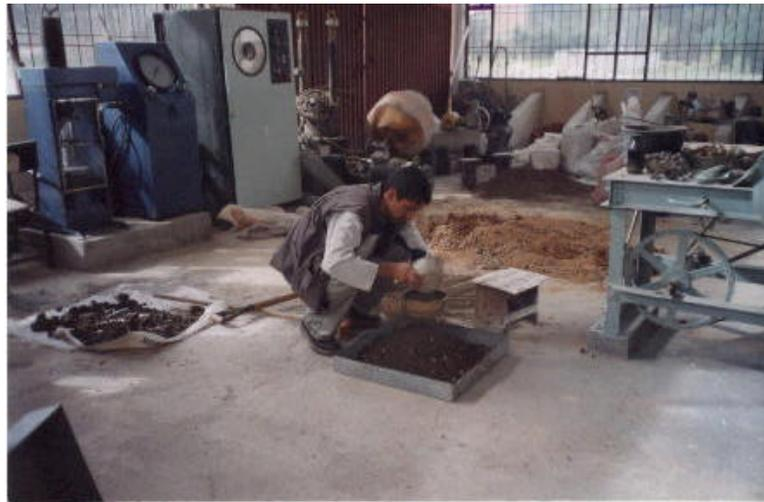
**Figura 125. Muestras de 6000 gr para ensayo de próctor**
