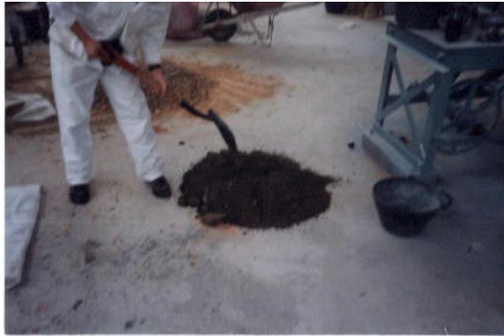
**Figura 119. Tamizado de material a través de la malla 3/8**
