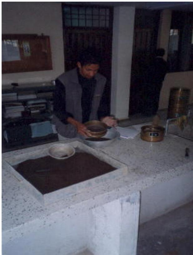
· **Procedimiento para ensayo de próctor.** El ensayo de Próctor normal o modificado se realiza de acuerdo a la norma I.N.V.E. – 142.
