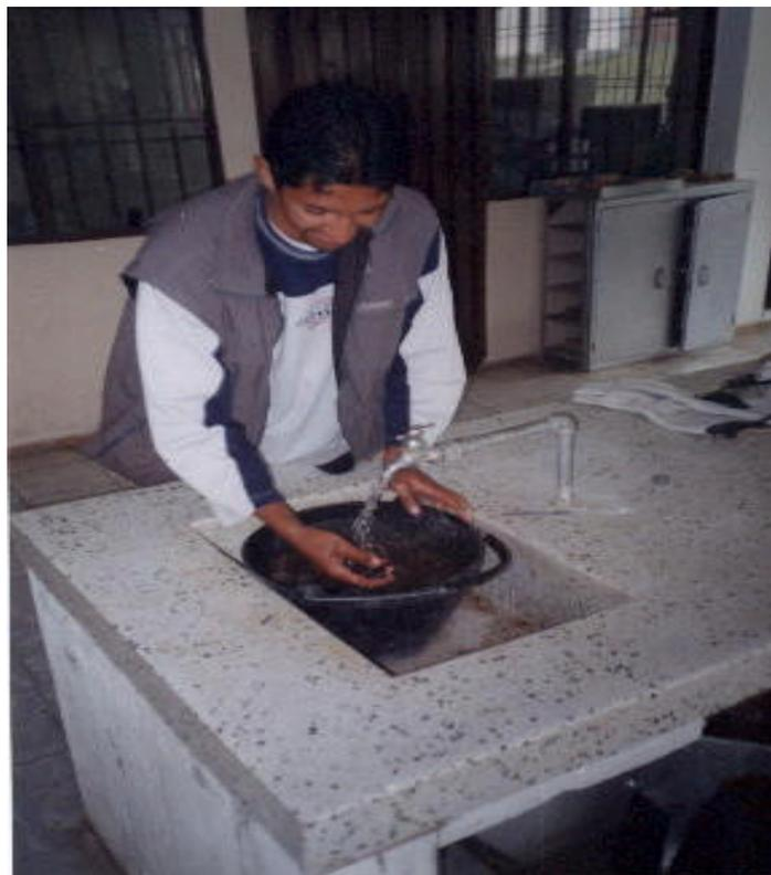
**Figura 122. Tamizado agregado grueso**
