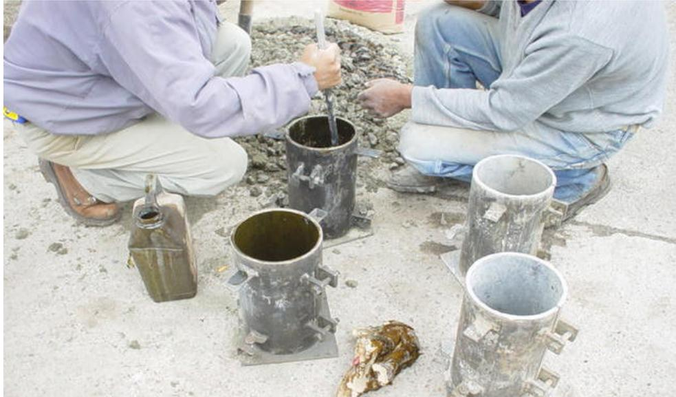
**Figura 137. Curado de cilindros**
