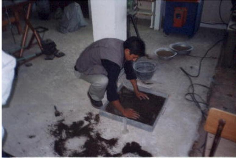
**Figura 127. Compactación de una capa de material en el Cilindro**
